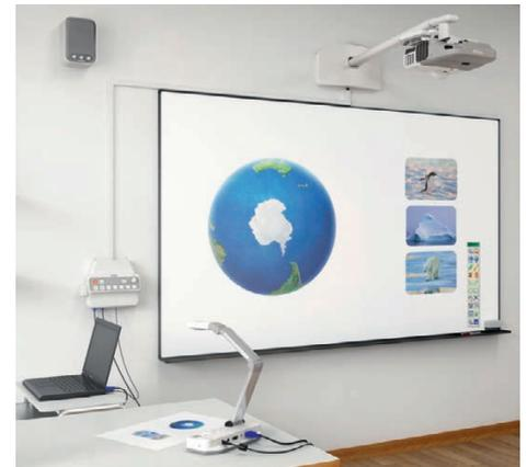
La solución Epson para la enseñanza: conecta el proyector a la caja de control y conexiones ELPCB01 para facilitar el acceso a los interruptores. El soporte para pared adaptado ELPMB27 agiliza la instalación.
